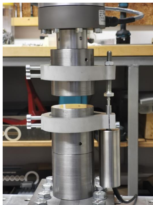
Slika: 2.2: Konfiguracija trgalnega stroja za tlačni preizkus.
