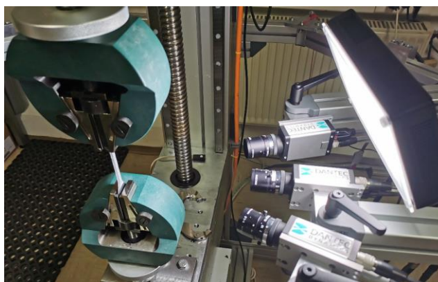
Slika 2.7: Natezni preizkus sekundarnega tesnila.
