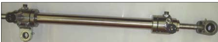
Slika 3. Videz izboljšanega vodnega hidravličnega valja
