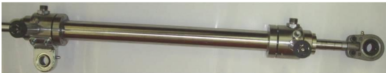
Slika 3: Izgled izboljšanega vodnega hidravličnega valja
