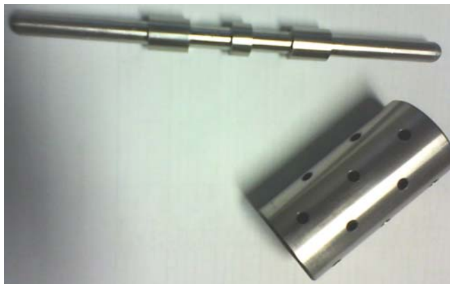
Slika 3: Krmilni bat in puša vodnega 4/3 proporcionalnega potnega ventila
