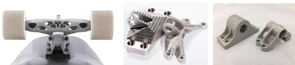
Slika 1: Primeri nosilcev, topološko optimiziranih za zmanjšanje mase
