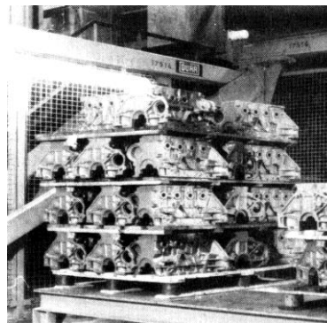
Slika 3.38. Surovci v neurejenem stanju, a – v zaboju, b – na paleti
