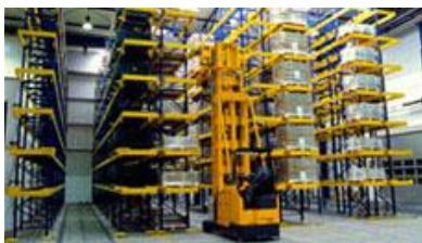
Slika 2.16. Strega z avtomatično vodenimi viličarji – mobilnimi roboti.
