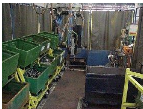
Slika 2.16. Zaboji na vozičkih ob varilnem mestu in ročno jemanje neposredno iz zabojev
