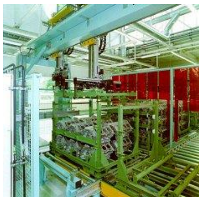
Slika 2.15. Avtomatizirano nalaganje v zaboje z okvirji oziroma jemanje iz zabojev
