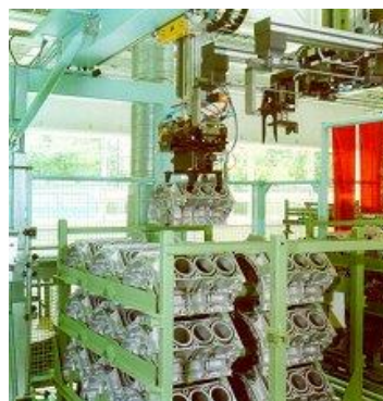
Slika 2.15. Avtomatizirano nalaganje v zaboje z okvirji oziroma jemanje iz zabojev
