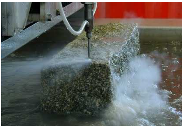
Slika 5.1: Primer rezanja z AVC
