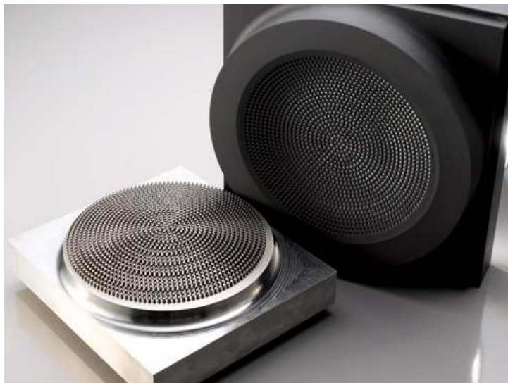
Slika 4.1: Primer preslikave oblike elektrode v obdelovanec
